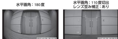
180 度のカメラアングルを設定した場合、魚眼レンズのため、画面が歪みます。110 度の場合は補正をかけていますが、多少の歪みが発生します。
