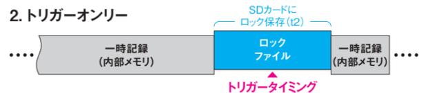
動画は、本体内部のメモリに一時記録されます。トリガー入力を受け付けると、トリガータイミングを中心とした、1つの動画ファイル (上書き禁止) を生成しSDカードに保存します (トリガーオンリー)。SDカードにはトリガー入力時のみの保存動作で、SDカードの長寿命化が期待できます。録画単位 (t2) の基本設定は、「20秒」「40秒」より選択できます。(トリガーが連続して入力された場合、1ファイル当たりの録画時間は延長されます。)
