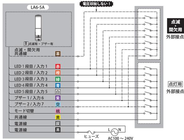
外部接点の種類 PLC (NPN型トランジスタ)
