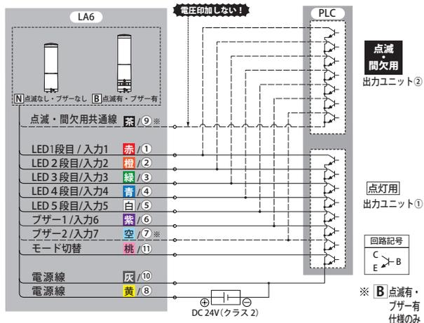
外部接点の種類 PLC (NPN型トランジスタ)
