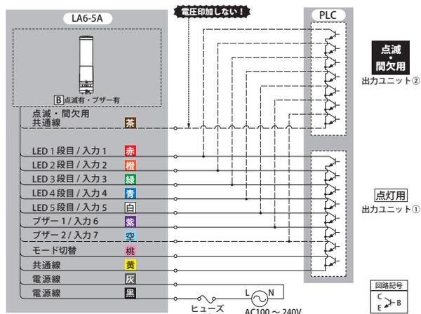
外部接点の種類 PLC (PNP型トランジスタ)
